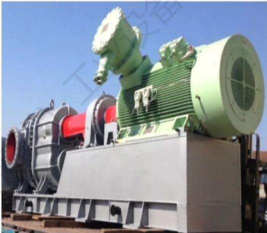
3000m³转子泵出口印度
